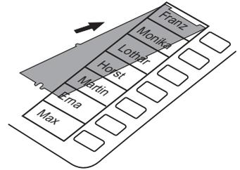
Kunststoffabdeckung entfernen: Mit einem passenden Werkzeug in die untere Öffnung der Abdeckung greifen und diese vom Telefon wegziehen, bis sie aus der Verankerung springt.
